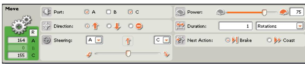
Il paraît plus formateur de choisir l'option avec les deux blocs *Moteur* : chaque organe est géré indépendamment des autres, ce qui permet de régler leurs paramètres propres, et donc de faire réagir le robot d'une façon plus fine.
