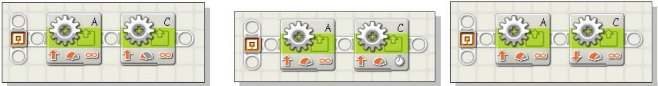
Par la suite, on intègre une contrainte de durée de déplacement : le robot doit avancer en ligne droite pendant trois secondes.
